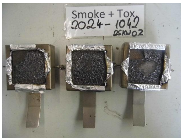
IMO Part 2: 25 kW ohne Zündflamme / 25 kW without ignition flame
