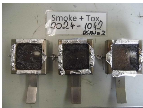
IMO Part 2: 25 kW mit Zündflamme / 25 kW with ignition flame
