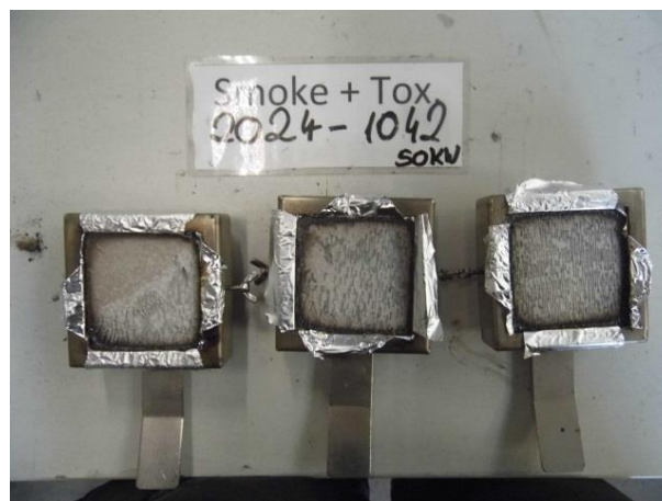
IMO Part 2: 50 kW ohne Zündflamme / 50 kW without ignition flame
